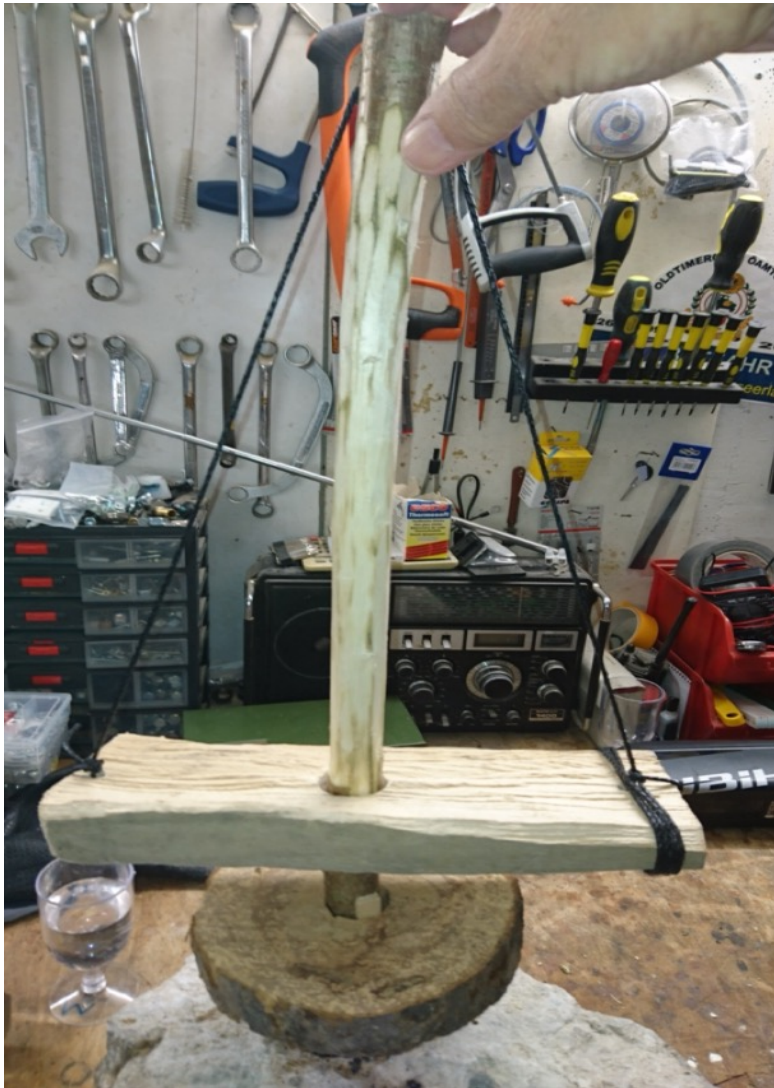
Pumpbohrer Version I mit zu steilem Aufrollwinkel
